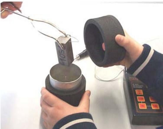
Leggiamo la temperatura dell'acqua bollente  $t_2$  nel pentolino e rapidamente spostiamo il corpo metallico nel calorimetro servendoci di una pinza metallica, evitando di versare acqua calda nel calorimetro.
